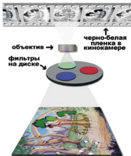
Схема съёмки анимационных фильмов по трёхцветной системе «Technicolor».
