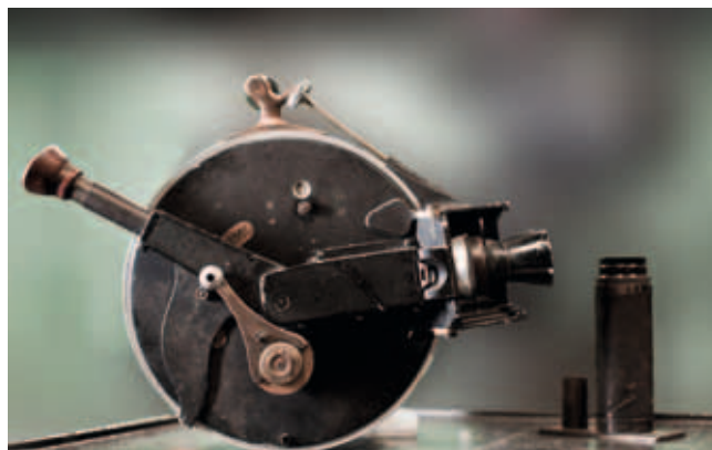
Фото 10. Кинокамера «Akeley» со сменными объективами
